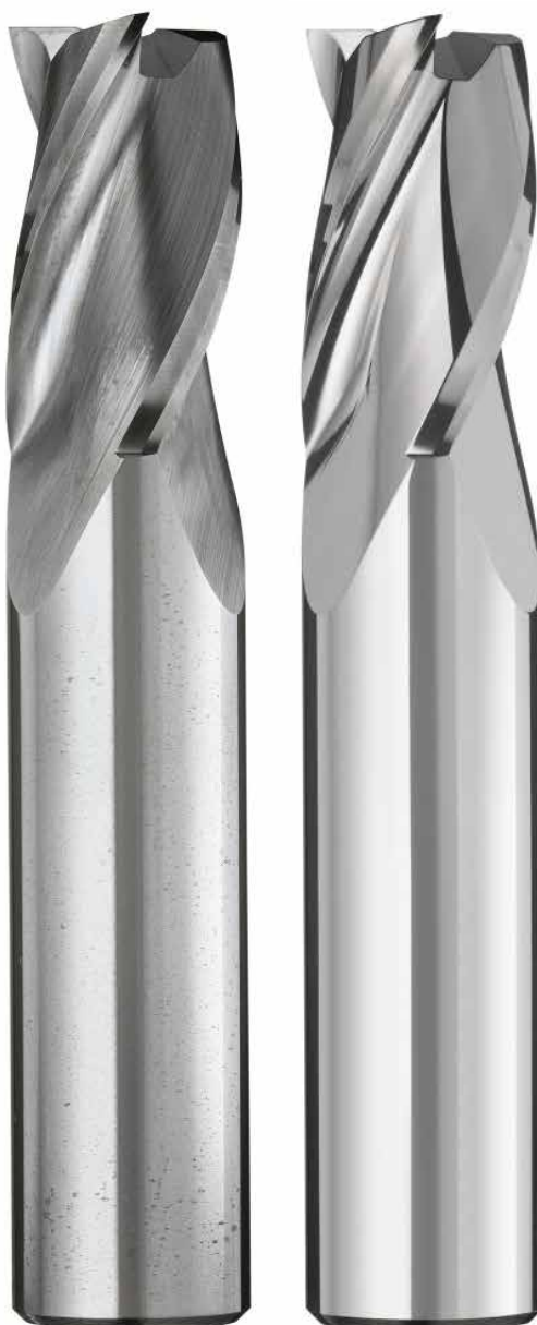
Fräser vorher-nachher: Ra unpoliert: 0,31 µm Ra poliert: 0,03 µm
