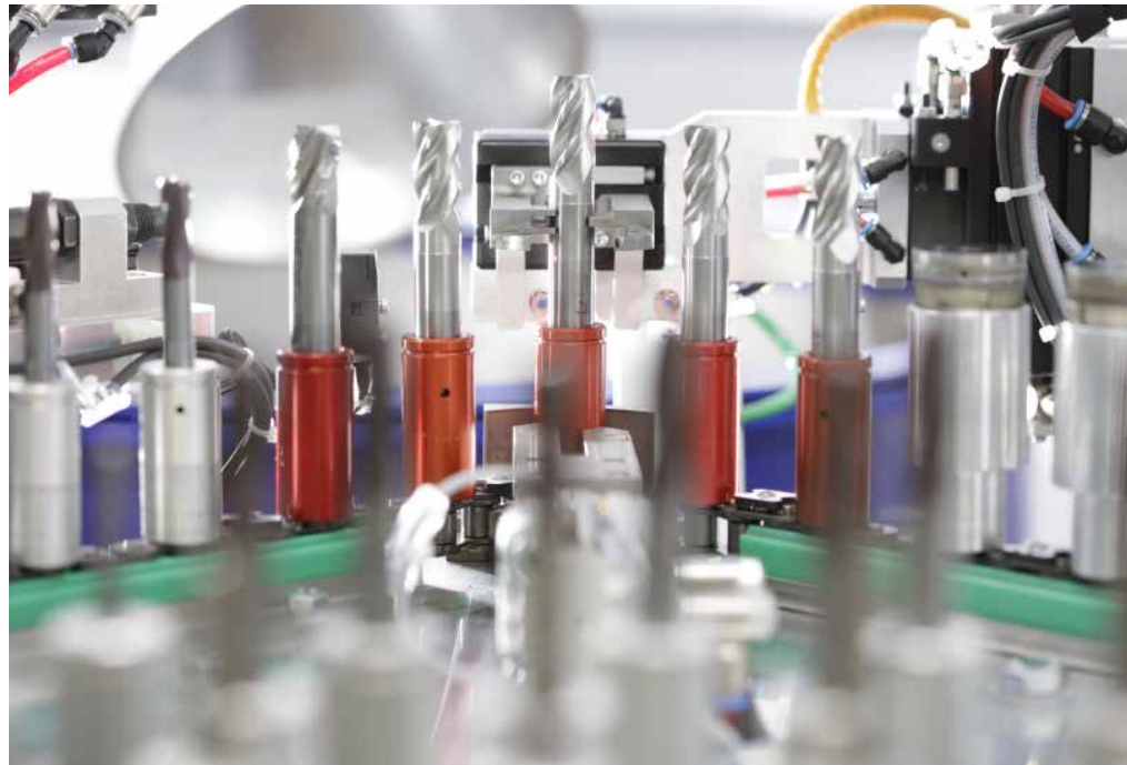
Automatischer Werkstückwechsel in der SF 1 ILS
