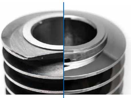
Förderschnecke vor und nach der Bearbeitung
