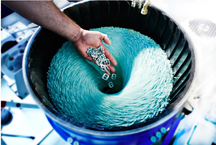
Procesamiento intensivo debido a diferentes fuerzas centrífugas
