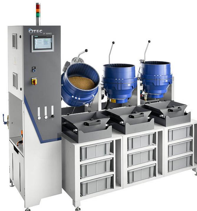
*Serie CF: Die modulare und kompakte Bauweise mit optimierter Schweißkonstruktion garantiert einen störungsfreien Betrieb und lange Lebensdauer.*
