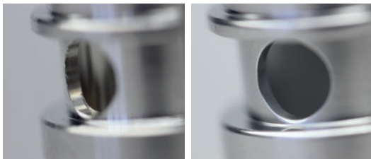
Пример: до удаления заусенцев, после полного удаления заусенцев
