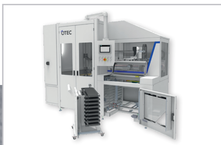
Chariot permettant de charger jusqu'à 9 palettes en même temps
