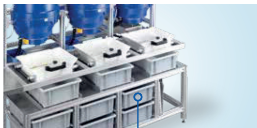
Dispositif de stockage de bacs en plastique supplémentaires pour produits de traitement
