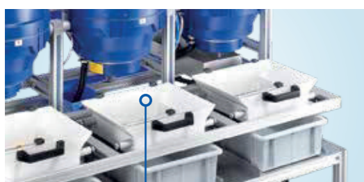
Unité de séparation manuelle par tamis à main
