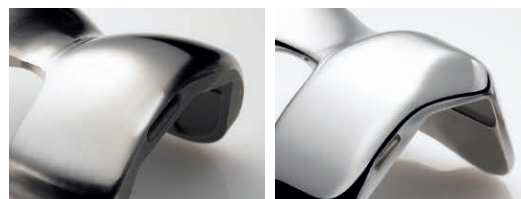
Exemple : surface à poli spéculaire d'une valeur Ra 0,01 µm
