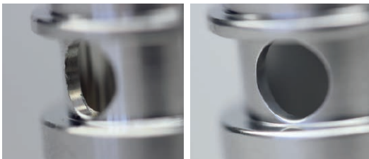
Exemple : avec bavure avant traitement, sans bavure après
