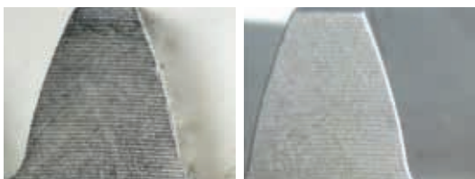
Пример: торец зуба до (слева) и после (справа) обработки.
