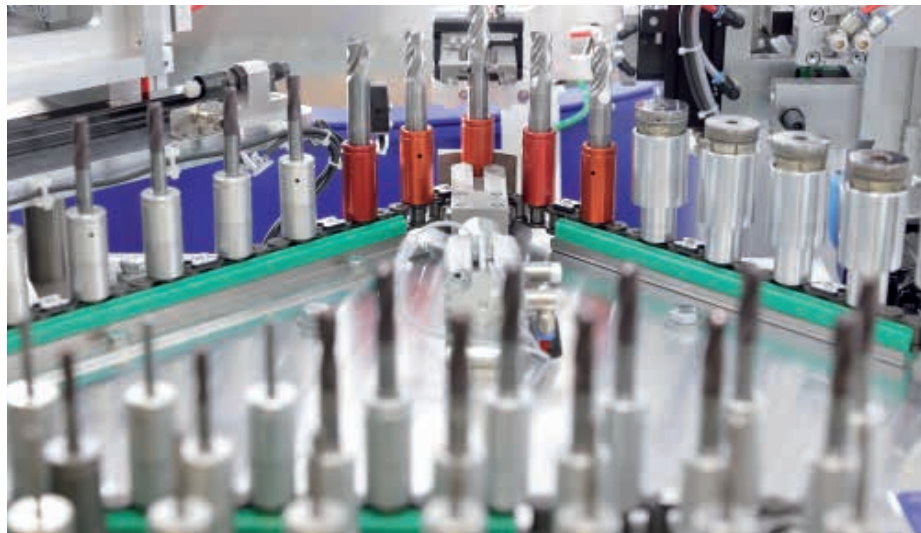
Цепной инструментальный магазин для станка SF 1 ILS
