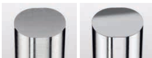
Пример: пуансон до (слева) и после (справа) обработки.
