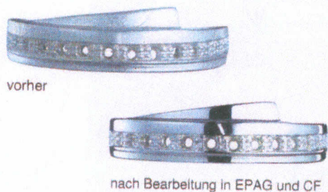
Abb. 1: Schmuckteil vor (oben) und nach der Bearbeitung mittels EPAG und CF
