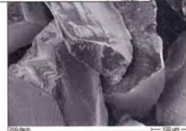
Bild 2. 'HSC 1/300' Superfinish-Granulat der Firma Otec, 56-fache (Mitte) und 200-fache (unten) Vergrößerung des Abrasivanteils
