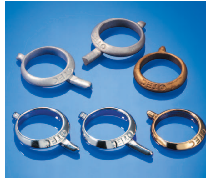
Gussringe: Ausgangszustand unversäubert/Resultat nach Bearbeitung mit ECO-mini „wet“ und „dry“
