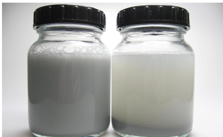
Abwasser ohne OTEC-Fällungsmittel – mit OTEC-Fällungsmittel
