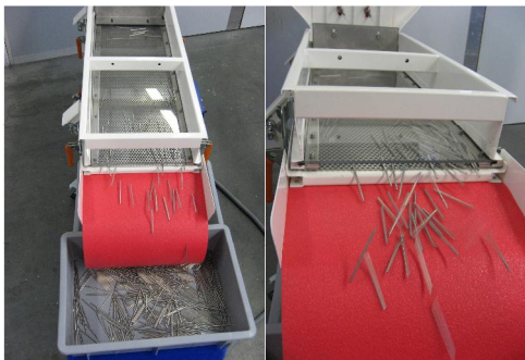
Bild 2 und 3: Neue Siebvorrichtung für die UNISEPA zur Separierung langer, dünner Werkstücke
