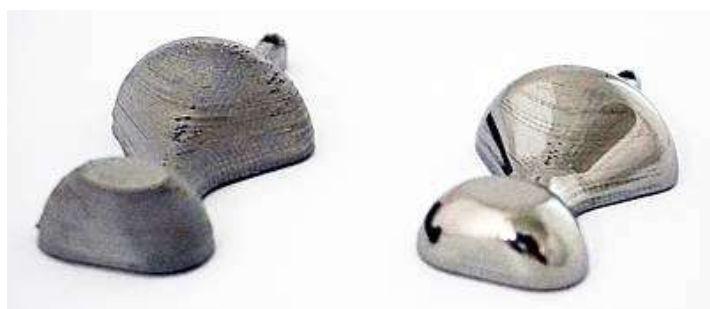
Przykład wyrobu wydrukowanego 3D (SLS) przez SolidPro, przed (lewy) i po (prawy) obróbce w CF
