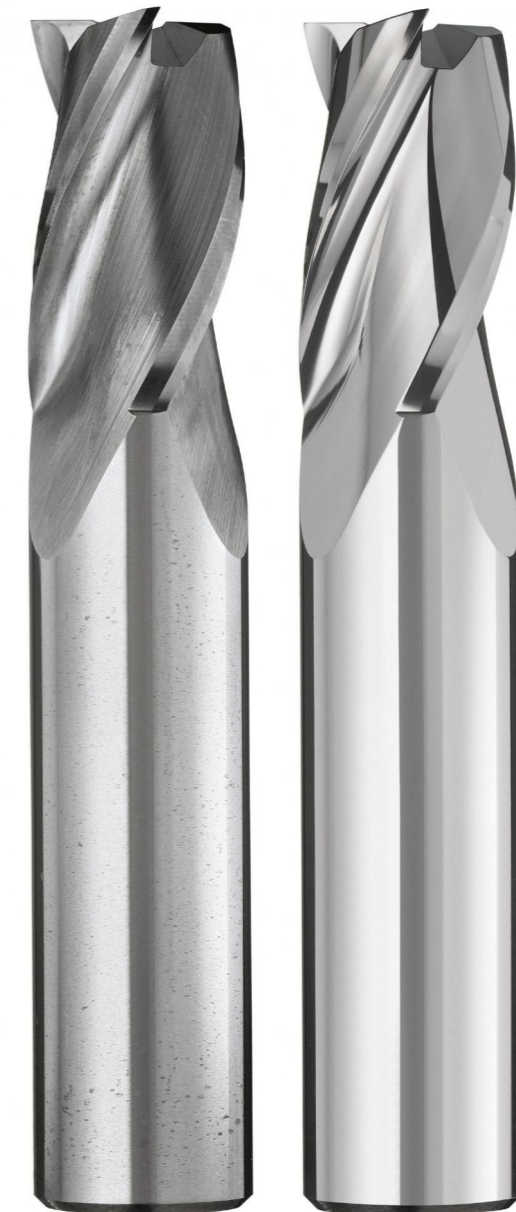
Fréza nástroj před a po: Hodnota Ra – nevyleštěno: 0,31 μm Hodnota Ra – vyleštěno: 0,03 μm
