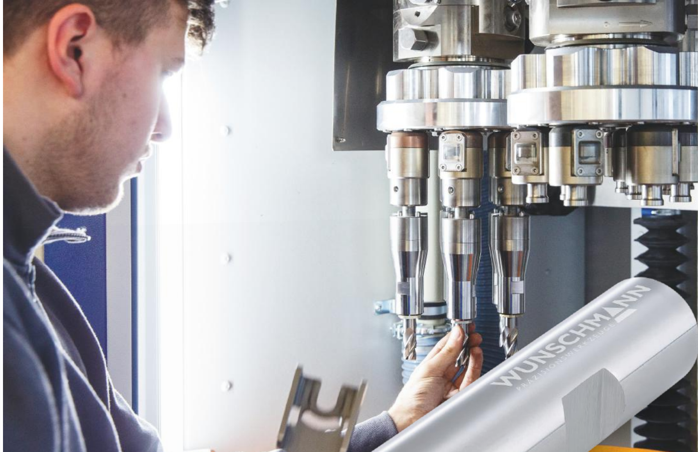
Zařízení pro vlečné omílání ve společnosti Wunschmann, zákazníka OTEC
