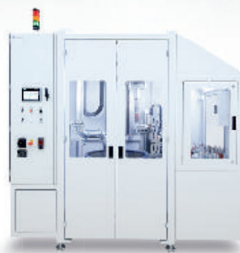
OTEK SF1-ILS Zřízení pro proudové omílání s automatickým vkládáním
