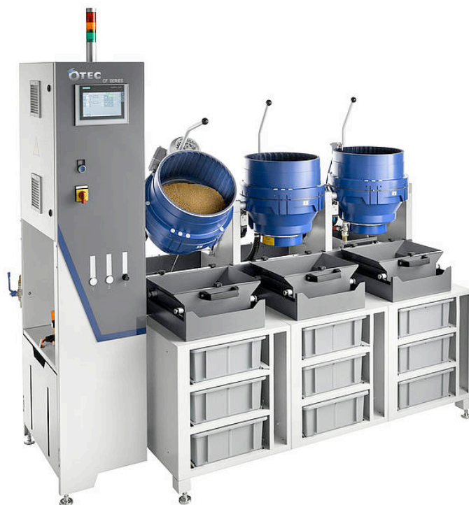
Serie CF: la struttura modulare e compatta saldata garantisce il funzionamento perfetto e la lunga durata utile.
