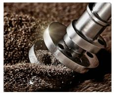
pièce elle-même en rotation. La SF permet de réaliser plusieurs étapes de traitement très rapidement en une seule passe. Ainsi, une pièce peut être successivement ébavurée, rayonnée, lissée et polie sans manœuvres supplémentaires. L'avantage décisif apporté par ce procédé pour le traitement de géométries internes telles que les prothèses de genou à charnière résulte de la séquence de mouvement à trajectoire contrôlée et de l'angle de la pièce qui peut être adapté à
