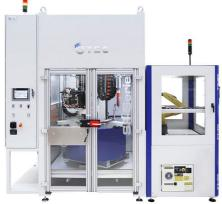
Lorsqu'il s'agit de traiter de grandes quantités de pièces, la rapidité de chargement et de préparation devient un facteur d'efficacité essentiel. Pour y parvenir, le chargement est automatisé à l'aide de robots (SF RLS, voir illustration à gauche). Les machines de la Série SF Automation peuvent être commandées avec ou sans technologie Pulsfinish et conviennent notamment pour les lignes de production cadencées. En fonction des besoins, les ma-
