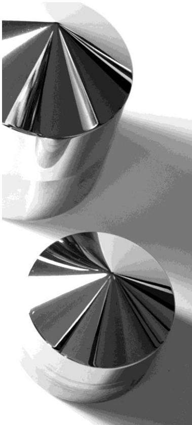
In der Schleppschleifanlage DF-3 HD für Nass- und Trockenbearbeitung können 12 Produktionsstempel gleichzeitig im Nassprozess geschliffen und anschließend trocken poliert werden.
