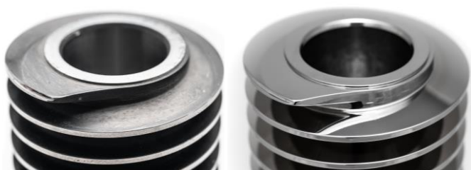
Vis avant (à gauche) et après traitement (à droite) par polissage à flux continu OTECE
