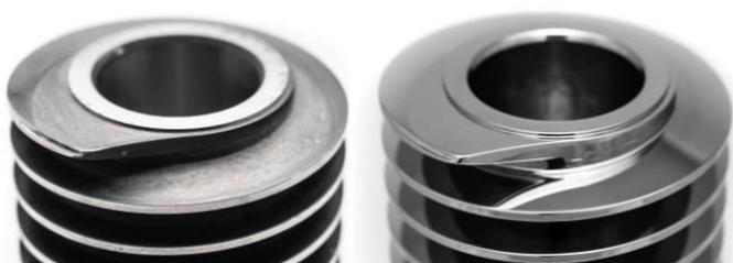
Trasportatore a coclea prima (a sinistra) e dopo (a destra) la finitura con il sistema Streamfinish di OTEC
