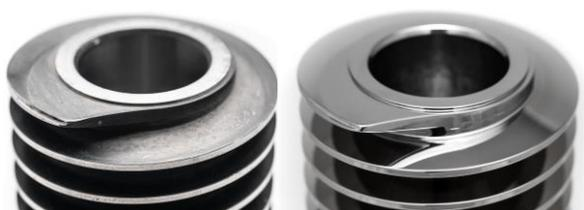
Vis d'extrudeuse avant (à gauche) et après (à droite) le traitement avec finition du flux OTEC
