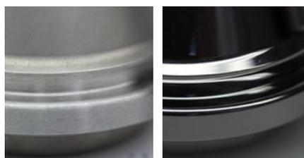
Rouleau de sertissage 0,44 µm avant (à gauche) et 0,05 µm après (à droite) traitement avec finition par flux OTEC
