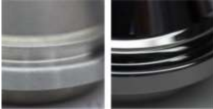
Rulli prima (0,44 \mu\text{m} , a sx) e dopo (0,05 \mu\text{m} , a dx) la finitura con il sistema Streamfinish di OTEC
