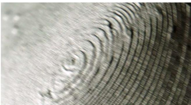
*Superficie con caratteristica struttura scanalata di un pezzo prodotto usando il processo SLS (pezzo SolidPro prima della finitura post-produzione)*
