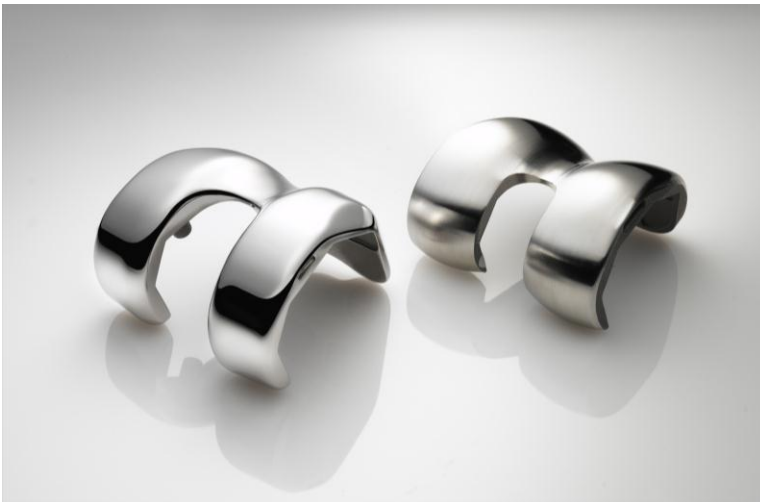
Kolenní kloub před (vpravo) a po procesu leštění (vlevo)
