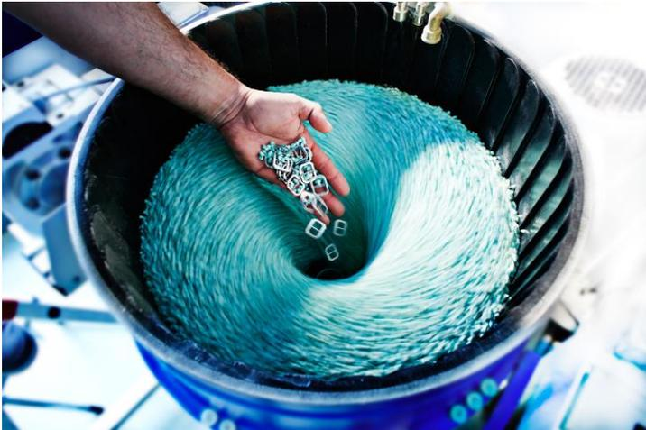
Intensive Bearbeitung durch unterschiedliche Fliehkräfte
