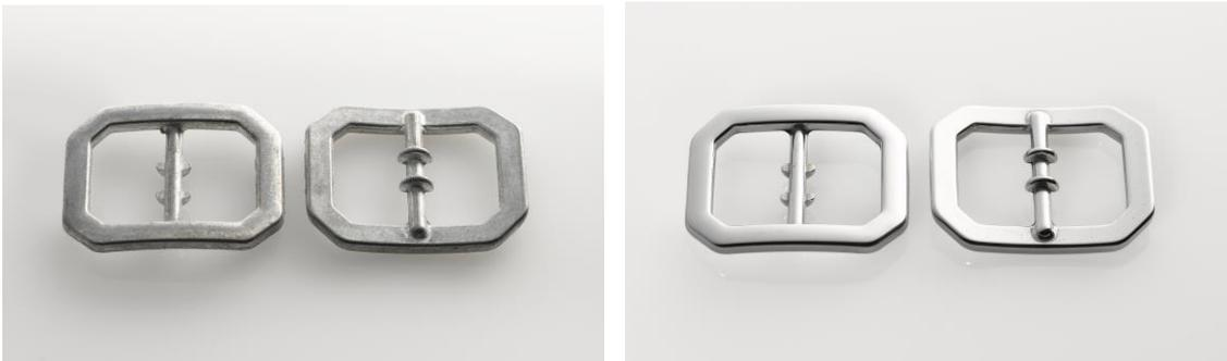
Gürtelschnalle vor und nach der Bearbeitung in der OTEC Tellerfliehkraftanlage
