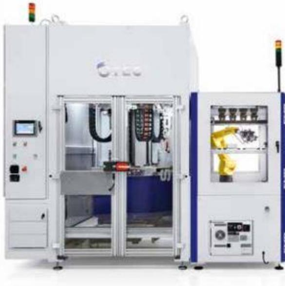
Bei der Bearbeitung von Werkstücken in großer Menge sind kürzeste Belade- und Rüstzeiten wichtige Effizienzfaktoren. Ermöglicht wird das durch die automatische Beladung mit Roboter (SF RLS, s. Abbildung links).
