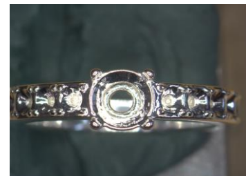
Filigraner, detailreicher Silberring nach der zweistufigen maschinellen Bearbeitung ( R_a \mu\text{m } 0,030 ), Quelle: OTEC
