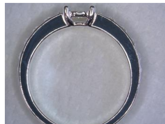
Filigraner, detailreicher Silberring nach der zweistufigen maschinellen Bearbeitung ( R_a \mu\text{m } 0,030 ), Quelle: OTEC
