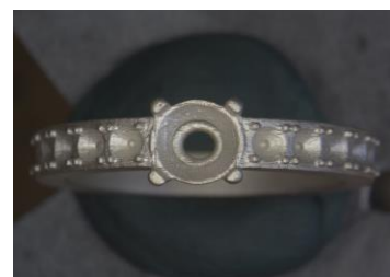
Filigraner, detailreicher Silberring vor der zweistufigen maschinellen Bearbeitung ( R_a \mu\text{m } 0,6 ); Quelle OTEC
