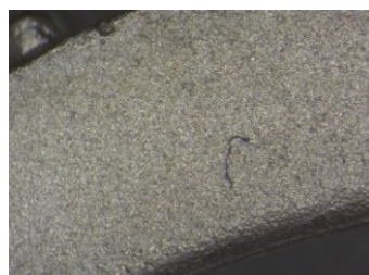
Filigraner, detailreicher Silberring vor der zweistufigen maschinellen Bearbeitung ( R_a \mu\text{m } 0,6 ); Quelle OTEC
