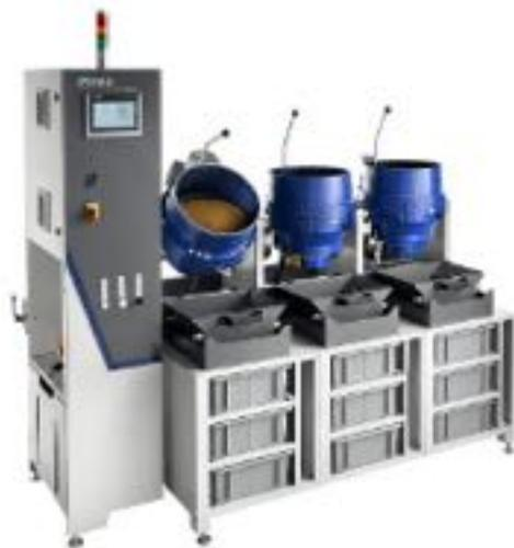
Dans une première étape, les bijoux sont préparés en phase humide dans les **machines à force centrifuge de la série CF** : le traitement a lieu dans une cuve ouverte disposant d'un fond en forme de plateau pivotant.
