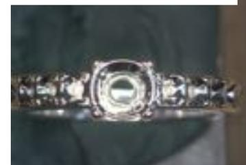
*Bague en argent très fine et riche en détails après traitement machine en 2 étapes ( $Ra \mu m 0,030$ ), source : OTEC*
