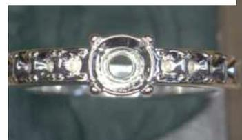
*Anello d'argento in filigrana ricco di dettagli dopo la lavorazione a due fasi ( $Ra \mu m 0,030$ ). Fonte: OTEC*
