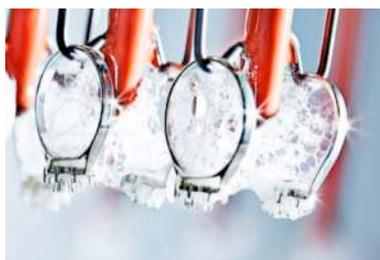
Nella seconda fase segue **l'elettrolucidatura nella EPAG Flex**: si tratta di un processo elettrochimico che si applica ai pezzi metallici e che utilizza una fonte di corrente elettrica esterna per levigare e lucidare le superfici. Nel corso del processo, il mate-
