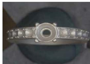
*Anello d'argento in filigrana ricco di dettagli dopo la lavorazione a due fasi ( $Ra \mu m 0,6$ ). Fonte: OTEC*
