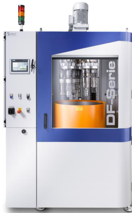
Máquina de arrastre tipo Schleppfinish DF-3 HD
