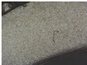
Skomplikowany srebrny pierścionek przed dwustopniową obróbką mechaniczną ( R_a \mu\text{m } 0,6 ). Źródło: OTEC.
