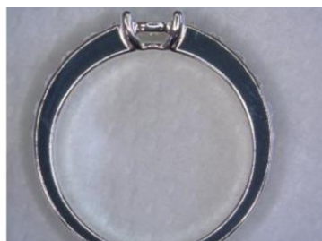
Skomplikowany srebrny pierścionek po dwustopniowej obróbce mechanicznej ( R_a \mu\text{m } 0,03 ). Źródło: OTEC.
