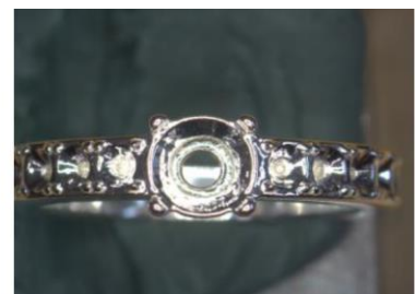
Skomplikowany srebrny pierścionek po dwustopniowej obróbce mechanicznej ( R_a \mu\text{m } 0,03 ). Źródło: OTEC.
