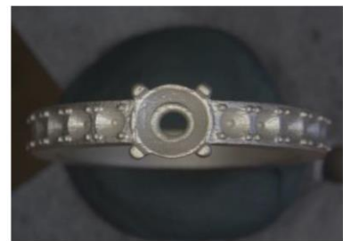
Skomplikowany srebrny pierścionek przed dwustopniową obróbką mechaniczną ( R_a \mu\text{m } 0,6 ). Źródło: OTEC.
