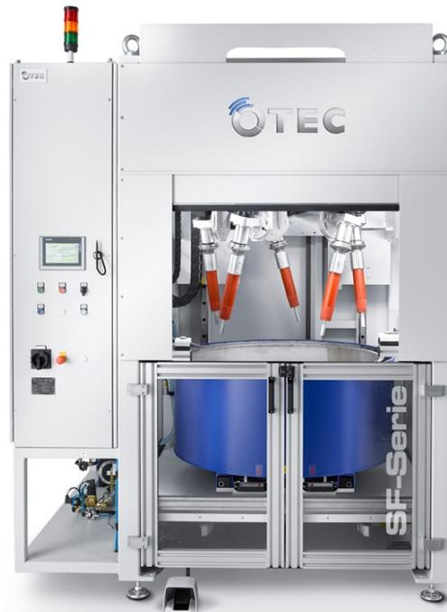
Durch die OTEC-Streamfinishanlage können selbst in kleinsten Spannuten glatte Oberflächen mit Rautiefen von Ra 0,02 µm erreicht werden. In der SF werden die Werkzeuge durch den gesteuerten Bewegungsablauf nur an definierten Stellen bearbeitet. Auf diese Weise wird ein schnellerer und gezielterer Abtrag als bei anderen Oberflächenbearbeitungsverfahren erreicht. Zusätzlich werden PKD-Schneiden effektiv geglättet. Die pneumatische Hubtür ermöglicht den schnellen Werkzeugwechsel.
