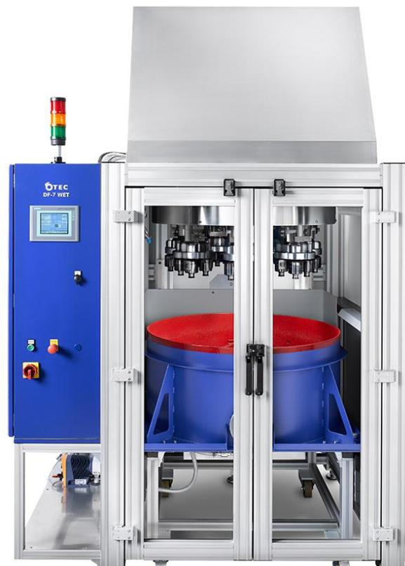
Schleppfinishanlage zur Bearbeitung von Kniegelenken
