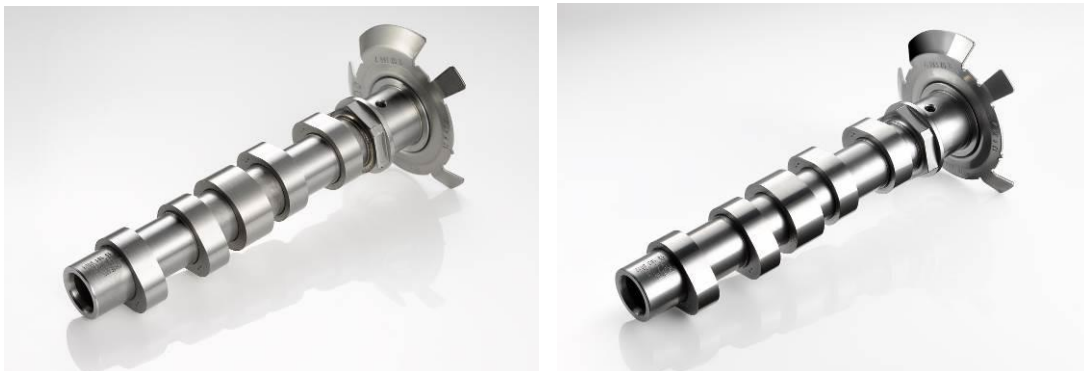
Nockenwelle eines Rennwagens vor (links) und nach (rechts) dem OTEC-Prozess
