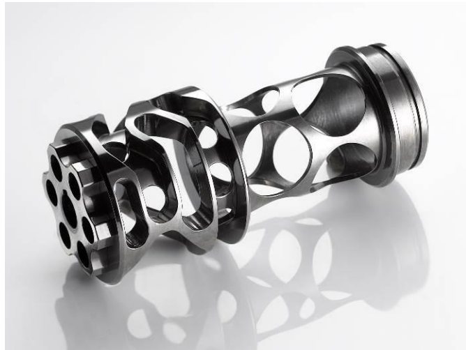
Schaltwalze nach der OTEC-Bearbeitung
