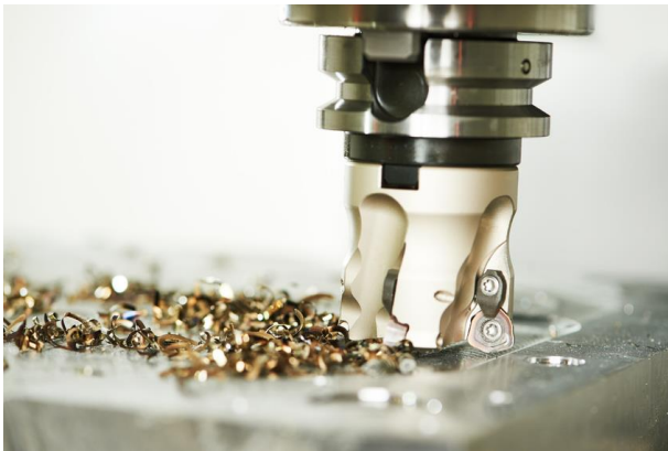
Trägerwerkzeug beim Zerspanungsprozess
