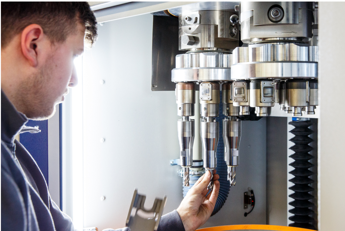
Schleppschleifanlage bei OTEC Kunde Wunschmann (Bildquelle: KRAAS & LACHMANN Werbeagentur GmbH, Tübingen)
