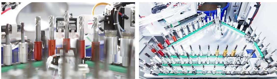
Automatická výměna nástroje s řetězovým podavačem
