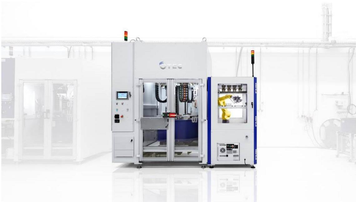
SF 3 RLS – Streamfinishmaschine mit automatischer Beladung
