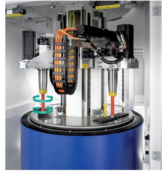
Die oszillierende Spindel wird in 1 Sekunde auf 2.000/Min. beschleunigt und abgebremst.
