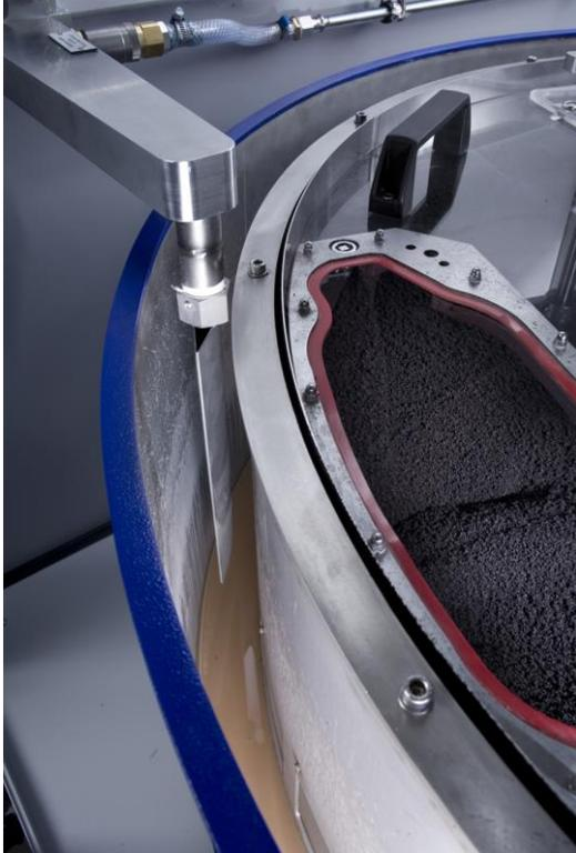
Bild 4: Absauglanze zum Absaugen des Abwassers
