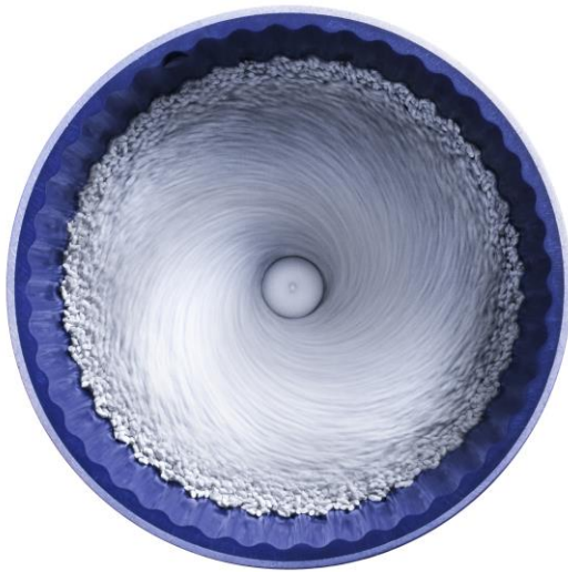
Entgraten und Verrunden mit dem Tellerfliehkraftverfahren
