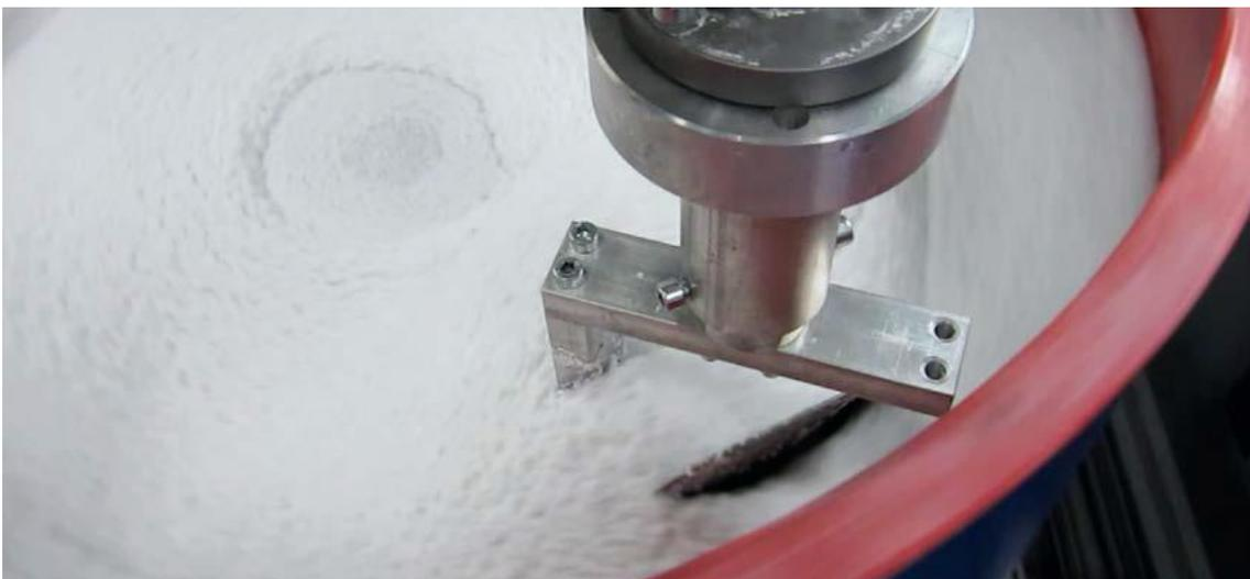
Einspannsituation der Turbinenschaufel während der Bearbeitung
