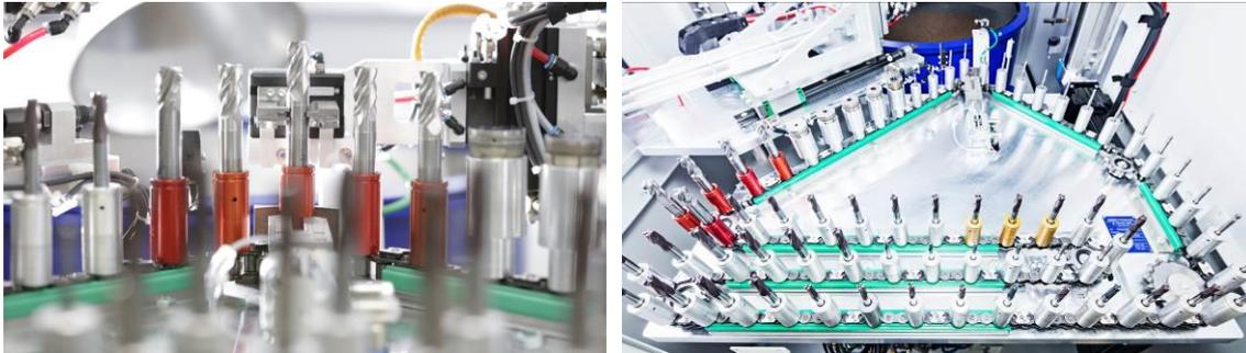
Cambio automático de pieza mediante cargador de cadena
