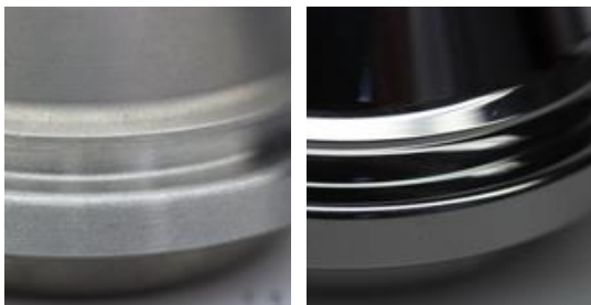
Formflächen der Dosenverschlusswerkzeuge vor und nach der OTEC-Bearbeitung
