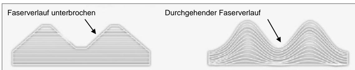
Faserverlauf bei spanend (links) und umformend (rechts) hergestellten Gewindewerkzeugen
