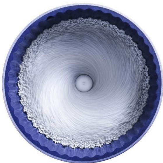
Odjehlení a zaoblení hran pomocí techniky odstředivého omílání
