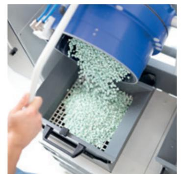
Einfaches Entleeren des Behälters
