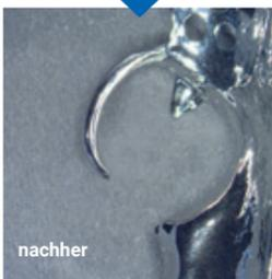
Auch die Innenbereiche von Klammerprothesen werden durch die EF-Smart T geglättet und poliert.
